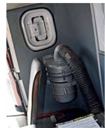
Filtr powietrza znajduje się tuż za siedzeniem pasażera
