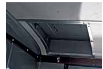
Kłapa w dachu dla obsługującego działko wodno-pianowe
