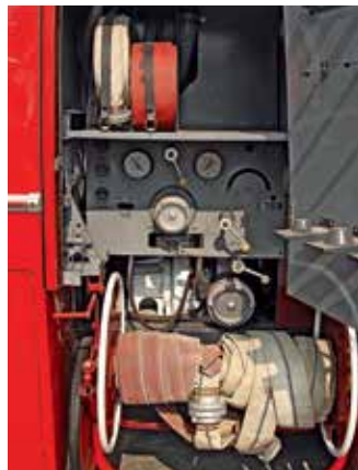
Star dysponował 200 mb węży tłocznych W-75 i 75 mb W-52
